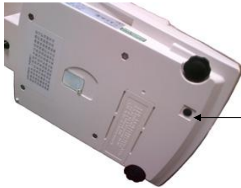
Рисунок 2 - Схема пломбировки от несанкционированного доступа.
